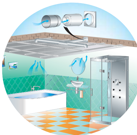
VKO1 fan flat ventilation example
